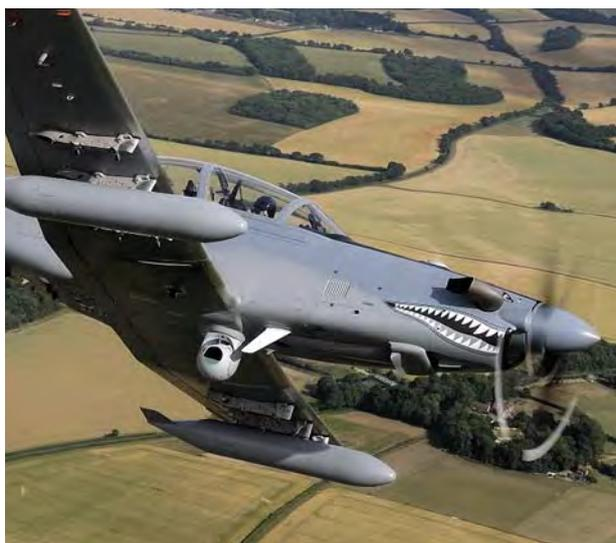
Гиростабилизированная турель хорошо видна под фюзеляжем самолета AT-6B
